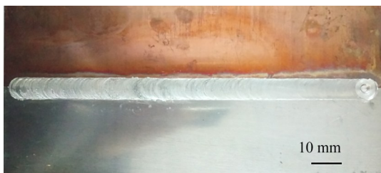
图2 Al-Cu焊态接头表面成型照片
