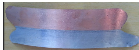
图4 焊后冷轧接头表面照片
